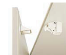
ストッパーが降りて扉をロック。揺れ が収まるとロックを解除します。
